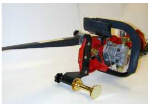
VAIHE 5 Kiinnitä akseli kiinnitysalustaan kuvatulla tavalla ja kiinnitä pultti tiukasti.
