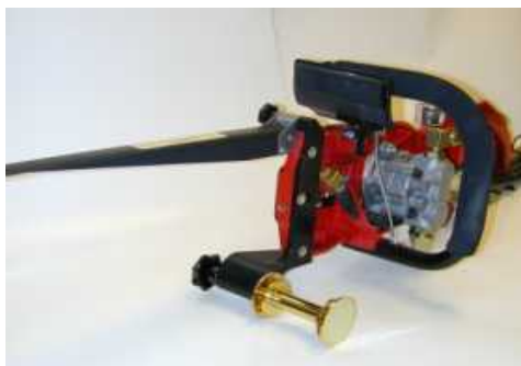
FASE 5 Inserire l'asse nel supporto braccio come mostra la foto e serrate fermamente l'impugnatura.
